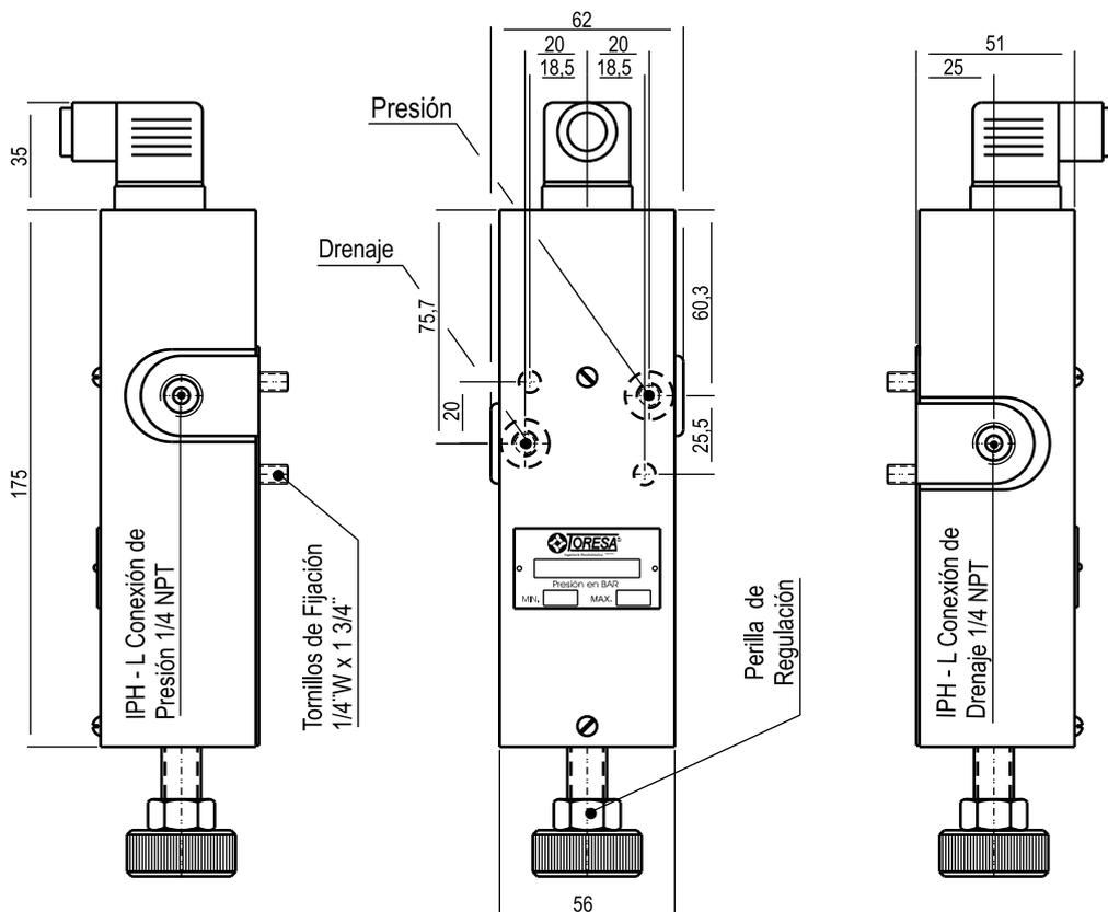
**FUNCIONAMIENTO:** La función de estos elementos es actuar microinterruptores al producirse una variación de presión en el circuito hidráulico, de acuerdo a valores preestablecidos.
